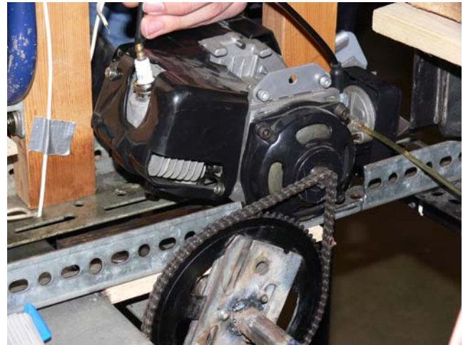
Abbildung 5-4: Kraftübertragung vom Motor auf die Achse
